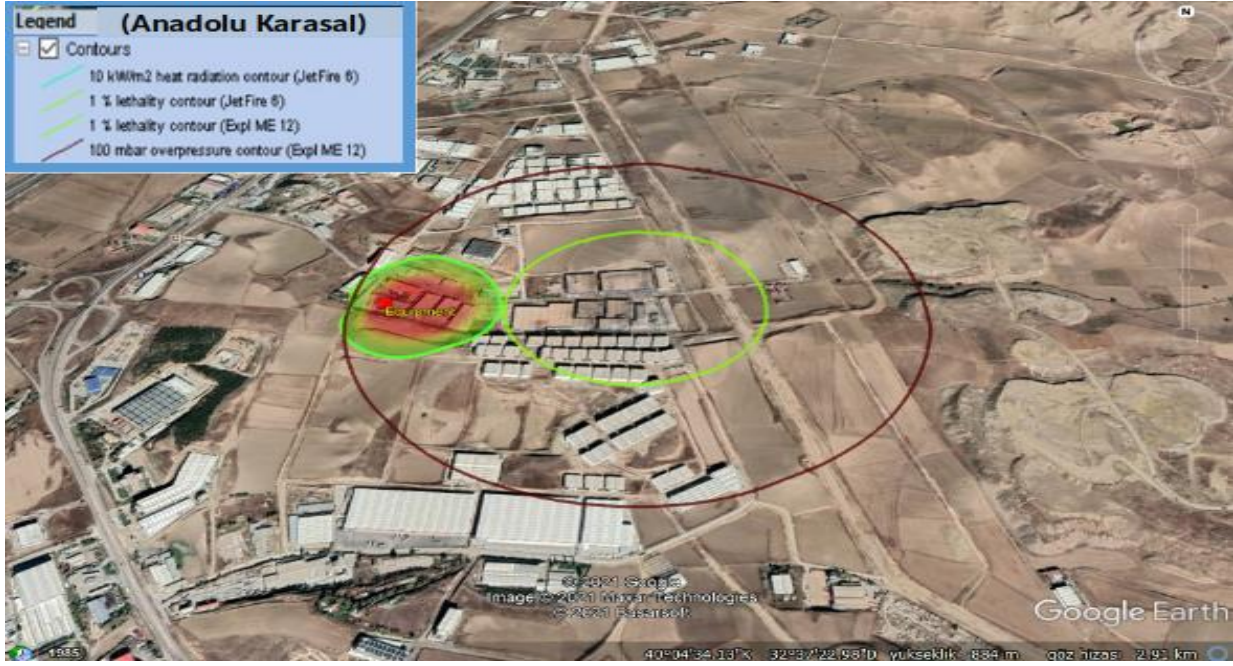
Şekil 2.23. Anadolu Karasal LPG Depolama Nakliyat ve Ticaret A.Ş.'ne Air Tehlike Analizi
